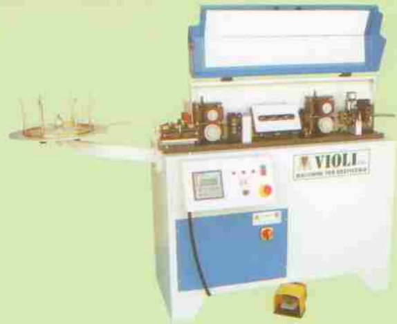
RADDRIZZATRICE PER FILO CON TAGLIO AUTOMATICO MOD. VM/MRF AUTOMATIC WIRE STRAIGHTENING AND CUTTING MACHINE MOD. VM/MRF
